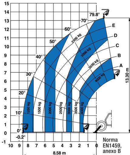
Sobre estabilizadores con plumin 2m (mecánico)
