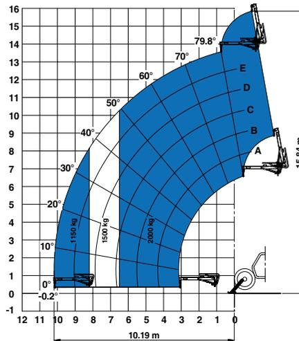
Sobre estabilizadores con plumin 4 m (mecánico/hidráulico)
